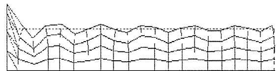
Figura 3. Modo fundamental da cerâmica sem apodização. Freq. = 2041,4 kHz, U_{zmax} = 5458,6 .
