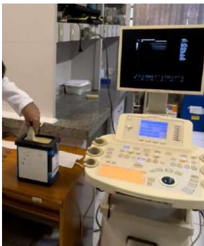
Fig. 4 – Montagem experimental 3 (a esquerda o phantom com um transdutor acoplado e a direita um aparelho de ultrassom).
