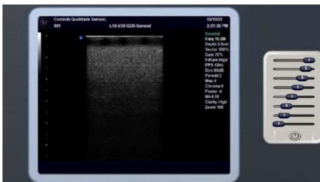
Fig. 8 – Tela da máquina de Ultrassom e a direita os controles do TGC.
