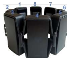
Fig. 2: Armband comercial Myo e a indicação dos 8 canais.
