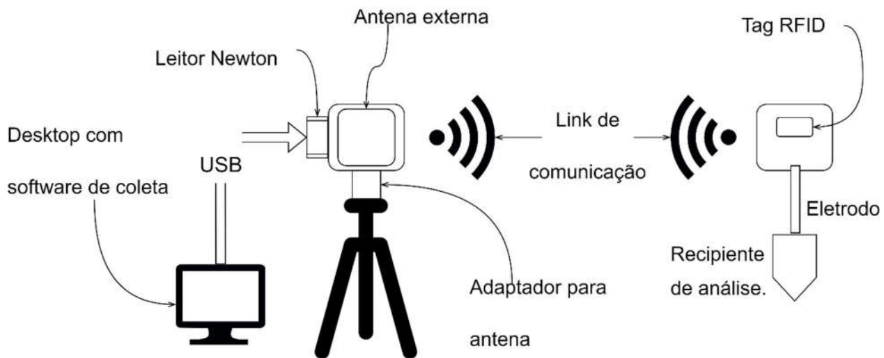
Fig. 1- Arquitetura utilizada para medição dos dados de pH remotamente através da tecnologia RFID.
