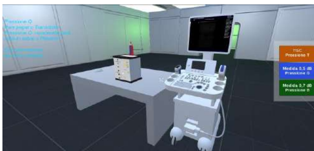
Fig. 7 – Montagem experimental virtual experimento 3. Da esquerda para direita: transdutor convexo, phantom de controle de qualidade com um transdutor linear acoplado, máquina de ultrassom e os botões do experimento.
