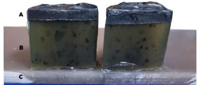
Figura 1: Visão frontal do phantom multicamada em corte sagital. (A) Camada de Phantom de Gordura; (B) Camada de Phantom de Músculo; (C) Camada de Phantom de Osso.
