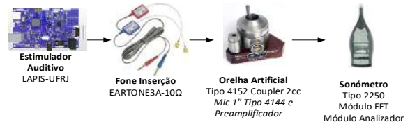
Fig. 2 Configuração para ajustar a pressão sonora dos estímulos auditivos
