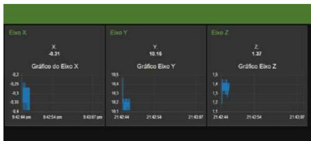
Fig. 1: Dashboard , interface de usuário, do sistema de visualização da oscilação de manobra de vibrocompressão por meio de aceleração triaxial com elementos gráficos e numéricos durante teste de aquisição de 3 segundos.
