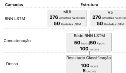
Figura 4: Arquitetura da Rede utilizada, com duas redes LSTM que se concatenam em uma RNA, em que a saída indicará a qual das 5 classes a batida pertence.
