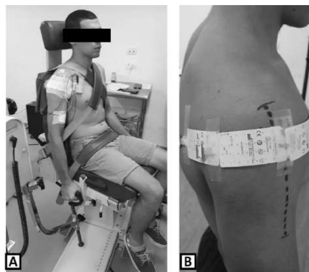
Fig. 1 (A) Posicionamento das 3 matrizes de eletrodos utilizadas para adquirir os eletromiogramas do músculo deltoide. (B) Uma linha de referência foi traçada para que, com o auxílio da ultrassonografia, as bordas das porções anterior e posterior do deltoide fossem identificadas.
