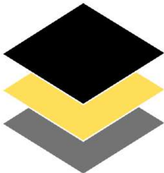
Fig. 1 Sensor resistivo flexível, visão frontal. Em cinza está a camada adesiva, em amarelo a PCB e em preto o Velostat.
