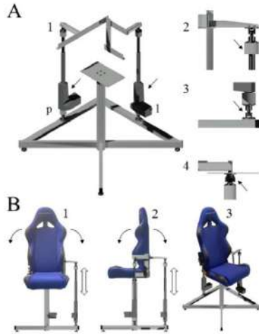
Fig. 2: Em A, vista em perspectiva isométrica do quadro do módulo. (1) As setas indicam os atuadores lineares posterior (p) e lateral (l), (2) peça em Nylon para fixação das juntas às extremidades dos atuadores, (3) junta universal dos atuadores, (4) junta universal do centro da base. Em B, vistas frontal, lateral esquerda e em perspectiva isométrica 1, 2 e 3, respectivamente do módulo. As setas indicam os movimentos do módulo e dos atuadores.
