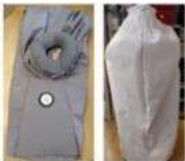
Fig. 3 – Cápsulas para descontaminação por ozônio em poliuretano com fibras (à esquerda) e PVC (à direita).
