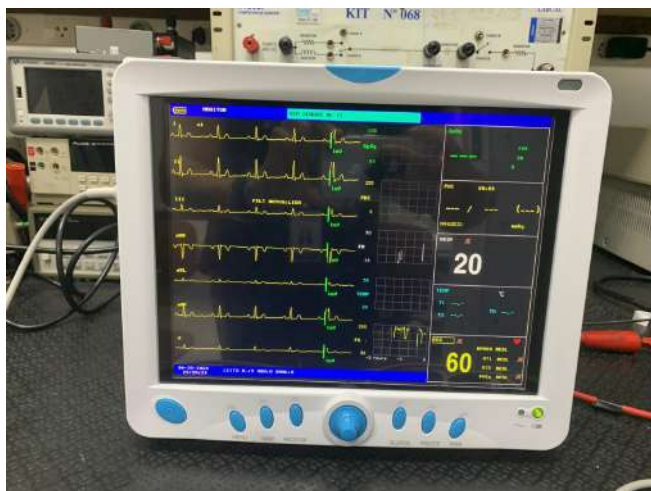
Fig. 8: Monitor multiparâmetro após ensaio de deminintegridade do cabo de paciente de ECG
