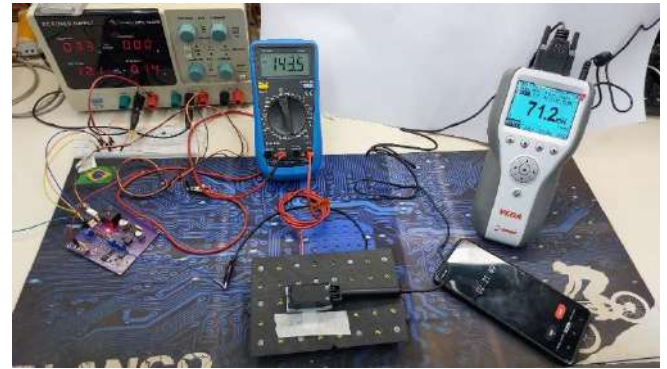
Fig. 5 Testes, ajuste e verificação da potência dos lasers e LEDs individualmente.
