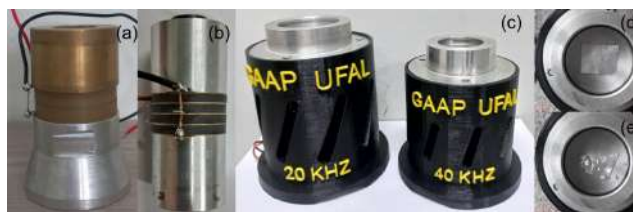
Figura 3: Transdutores Langevin construídos com frequência de ressonância de (a) 25 kHz e (b) 40 kHz. (c) Células ultrassônicas construídas. Folha de alumínio (d) antes e (e) depois do teste experimental utilizando a célula ultrassônica para gerar ondas sonoras de alta pressão. Essas ondas causam um processo chamado cavitação acústica, formando microbolhas que causam a erosão da folha de papel alumínio.
