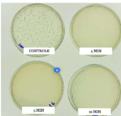
Fig. 6 - Exemplo de placas de Petri com E. coli após tratamento com ozônio gasoso na vestimenta de descontaminação. Controle (plaqueamento na diluição 10^{-8} a partir de suspensão de células) e nos tempos 5 min e 10 min (plaqueamento na diluição 10^{-5} a partir de suspensão de células).
