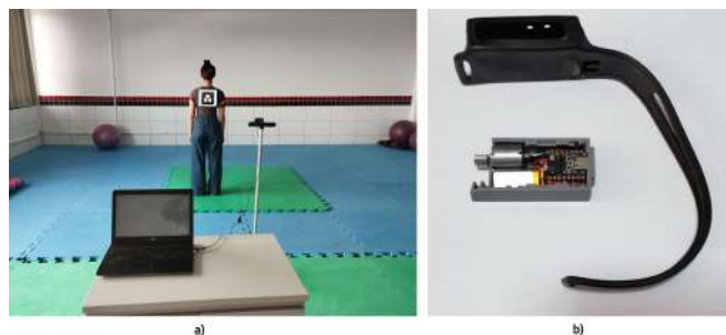
Fig. 3: a) Foto do esquema de posicionamento da câmera para captura da imagem da tag; b) Detalhe do dispositivo receptor e o case de acondicionamento.
