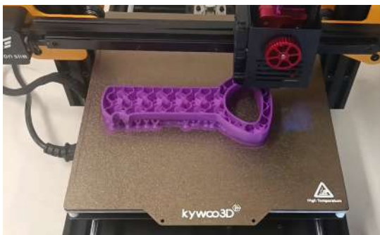
(b) Impressão de parte de prótese em uma impressora 3D
