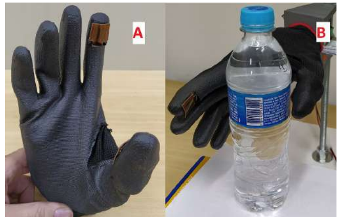
Fig. 2: A) Matriz de sensores piezorresistivos no dedo indicador da prótese. B) Prótese segurando garrafa e mostrando posicionamento dos sensores no experimento.
