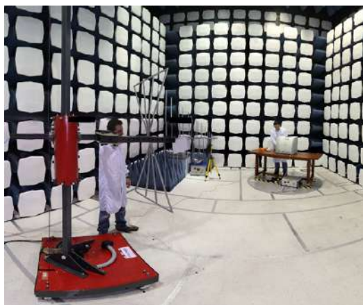
Fig. 2: Ensaio de EMC/EMI. Fonte: LIT-INPE
