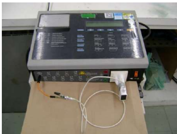
Fig. 3 Medição típica de corrente de fuga da parte tocada, por meio de um analisador de segurança (fonte: acervo do laboratório LGE).
